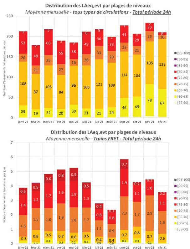
Figure 11 - Représentation mensuelle des niveaux de bruit ferroviaire au passage LAeq,event par plage de niveaux.
