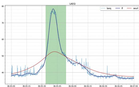
Figure 4 – Exemple de détection d'événement sonore.
